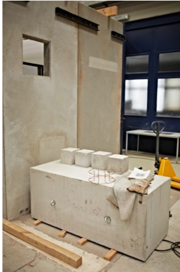
Sieht wie ein unspektakulärer Betonklotz aus, ist aber der Bestandteil eines Versuchs des Karlsruher Instituts für Technik, der die Außenwände von Atommeilern simulieren soll
