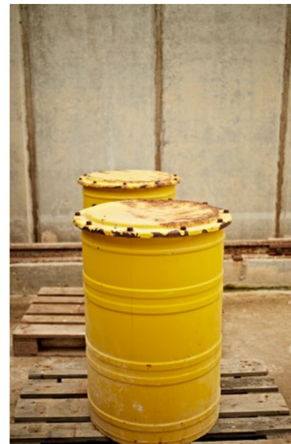
Mit welchen Maschinen ist es möglich, den Atommüll aus den Salzkammern zu bergen? Mithilfe dieser Fassattrappen werden Bagger, Fräsen und Bohrmaschinen getestet, die unter anderem beim Tunnelbau oder bei Bombenentschärfungen eingesetzt werden
